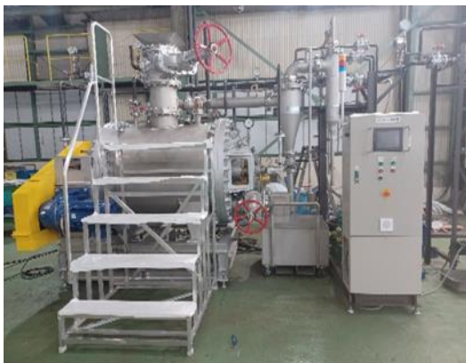
〔清本鐵工 食品殘渣回收設備〕
